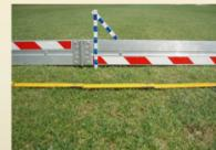
Die Ebenheit der Rasenfläche wird nach DIN EN 13036-7 mit einer Richtlatte über eine Messstrecke von 4 m Länge bestimmt.
