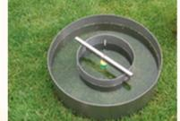
Die Infiltrationsrate wird mit dem Doppelringinfiltrometer gemessen. Die Durchführung der Messung erfolgt gemäß DIN EN 12616.
