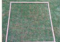
Die visuelle Bestimmung der Narbendichte (projektiven Bodendeckung) erfolgt mit einem Schätzrahmen analog DIN EN 12231 (Verfahren B).
