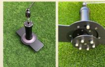
Der Drehwiderstand wird mit dem Leichten Drehwiderstandsgerät gemäß FIFA Quality Programme for Natural Playing Surfaces gemessen.
