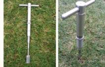
Die Messung der Scherfestigkeit erfolgt nach DIN 18035-4 in den oberen 4 cm der Rasentragschicht mit einer Flügelsonde.
