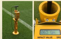
Der Clegg Impact Soil Tester (CIST bzw. Clegg-Hammer) misst die Oberflächenhärte beim Auftreffen eines Fallgewichts auf den Rasen.
